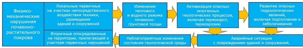
Рисунок 9.4.1: Схема распространения первичных и вторичных нарушений почвенного покрова и геологической среды в криолитозоне под воздействием строительства
